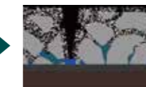
アルミ系酸化物生成物の充填を助けるとともに亜鉛リッチ相を温存。
