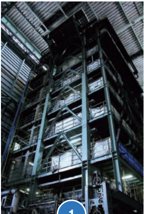
1 焼鈍炉 (縦型直火式還元炉)
