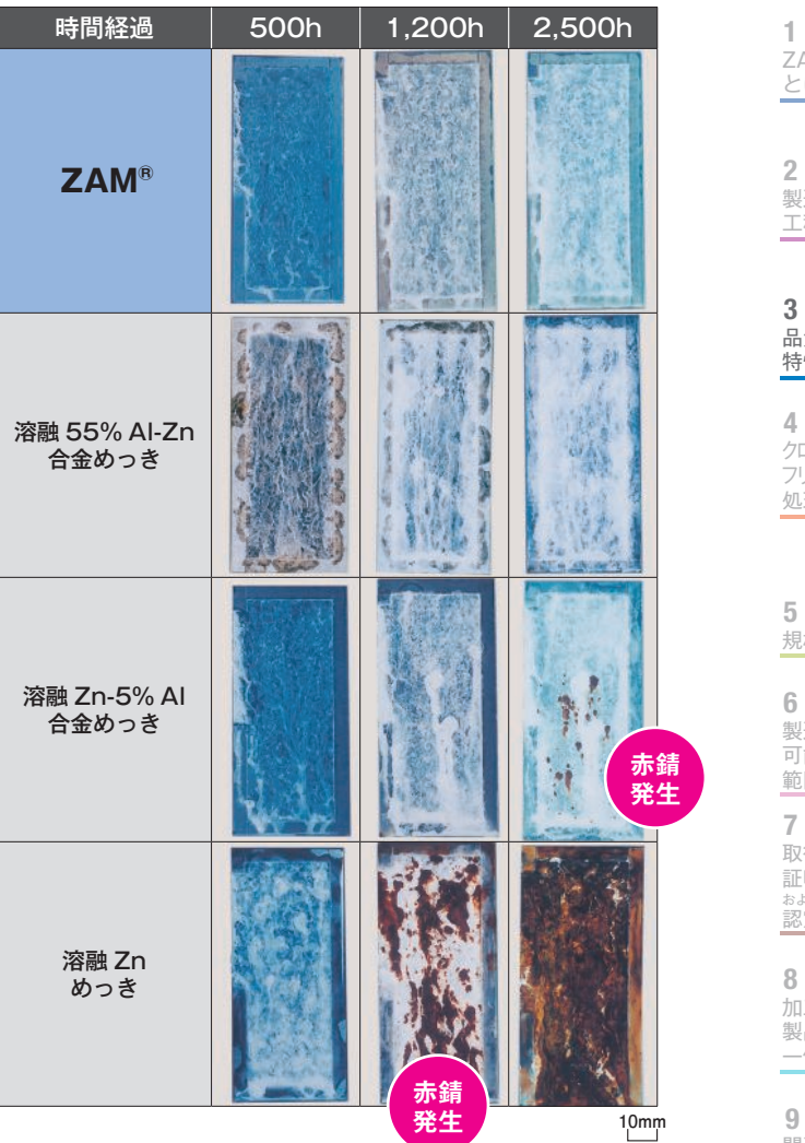
塩水噴霧試験結果(SST: JIS Z 2371) 塩水噴霧試験後の表面外観 (めっき付着量：90/90 g/m 2 、無処理)
